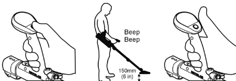
Figura 19: Procedimiento de Compensación por Terreno
